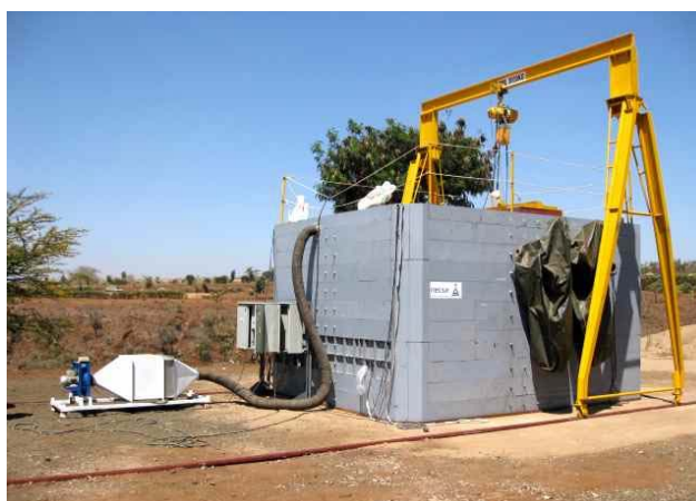
РИС. 2. Передвижная горячая камера, введенная в эксплуатацию в Объединенной Республике Танзании.
