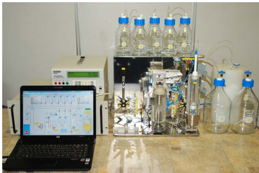
РИС. 1. "Камадхену" - полностью автоматизированный электрохимический генератор для производства стронция-90/иттрия-90, сконструированный и построенный компанией "Изотоп текнолоджи Дрезден" с использованием технологии, которая была разработана в рамках ПКИ Агентства. (Фотография любезно предоставлена Дж. Комором.)
