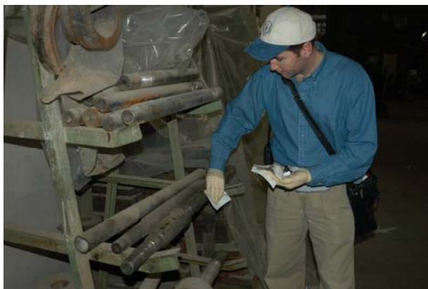
Рис. 4. Отбор проб окружающей среды на ядерной установке.
