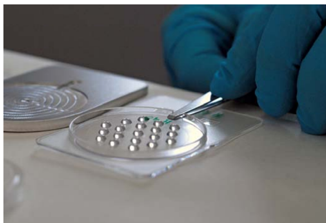
РИС. 4. Подготовка эталонных материалов, моделирующих воздушные фильтры, для аттестационной проверки АЛМЕРА.
