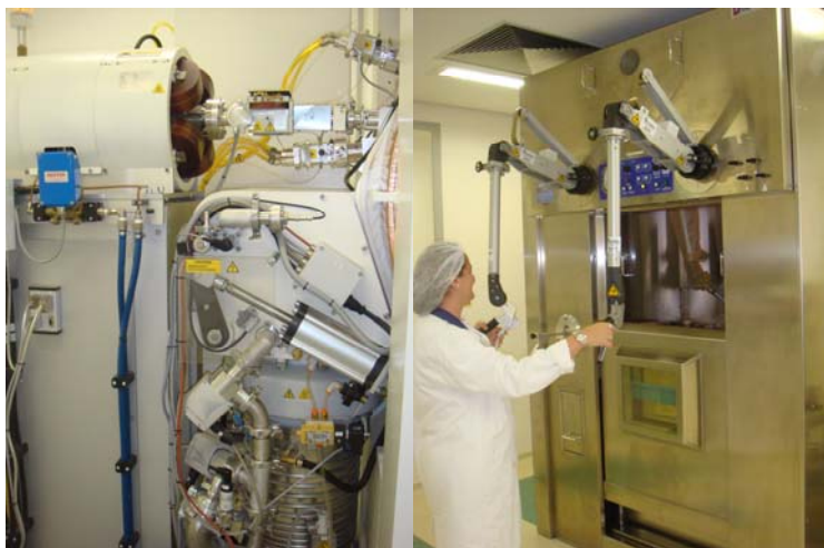
РИС. 2. Циклотронный лучевой экстрактор (слева) и производственная горячая камера (справа) для изготовления радионуклидов для ПЭТ в Ресифи, Бразилия.
