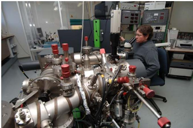
*Рис. 5. Масс-спектрометр вторичных ионов в АЛГ.*
