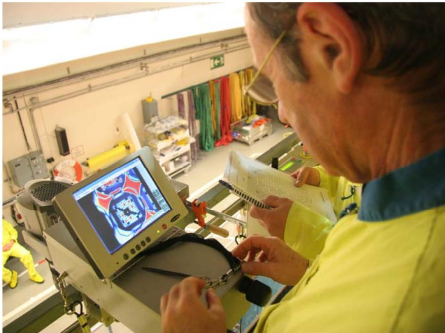
*РИС. 2. Проверка отработавшего топлива с использованием цифрового устройства для наблюдения излучения Черенкова.*
