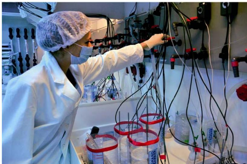
*РИС. 1. Экспериментальная система МАГАТЭ-ЛМС для оценки воздействия на промысловые морепродукты морской воды с пониженными значениями pH, которые прогнозируются моделями изменения климата.*
