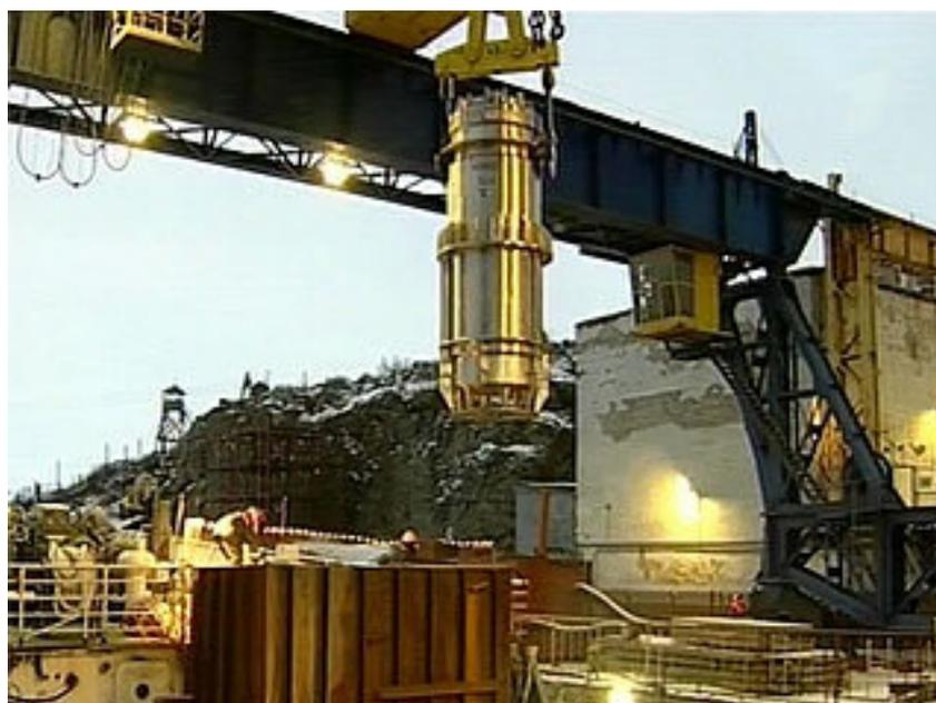
*РИС. 3. Удаление отработавшего ядерного топлива подводной лодки с бывшей военно-морской базы в бухте Гремяха для переработки на заводе "Маяк" в Российской Федерации.*
