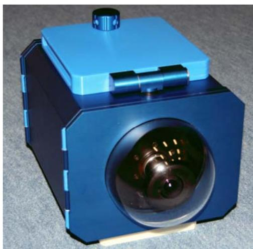
РИС. 4. Камера системы наблюдения следующего поколения.
