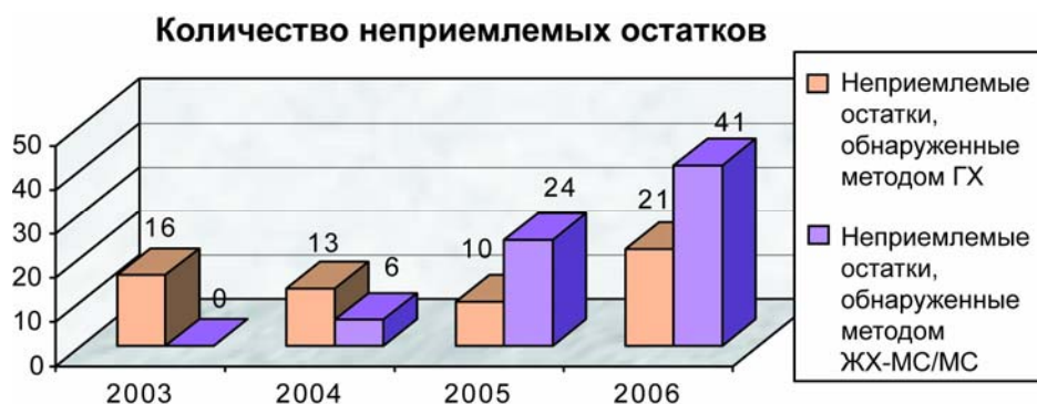
Рис. 3. Масс-спектрометрия в тандеме с жидкостной хроматографией повышает возможности анализа остатков пестицидов (ГХ: газовая хроматография; ЖХ-МС/МС: жидкостная хроматография - масс-спектрометрия/масс-спектрометрия).
