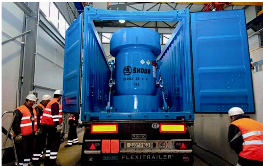
Рис. 2. Контейнер большой емкости, используемый для перевозки отработавшего топлива из Ржеже, Чешская Республика.
