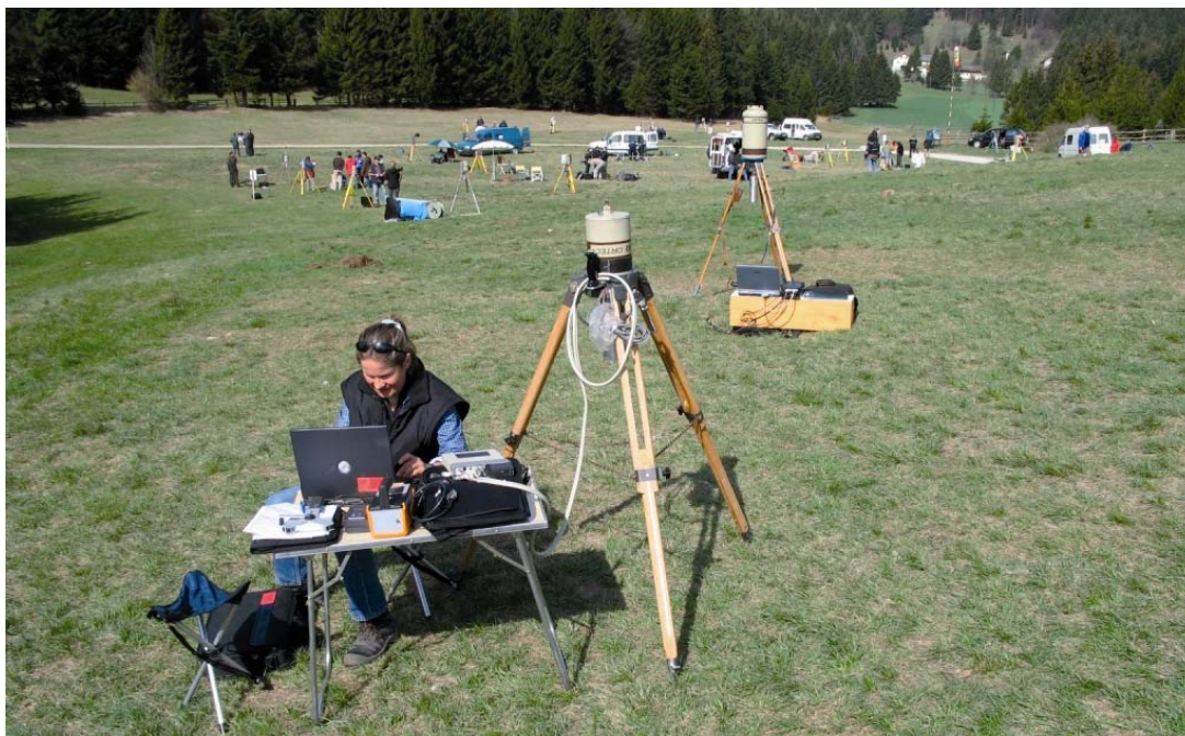
Рис. 2. Проверка работы гамма-спектрометрических систем высокого разрешения в полевых условиях в рамках осуществляемого в Австрии сценария мероприятия по взаимному сравнению.
