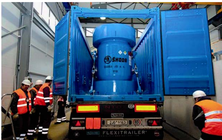
图 2. 运输来自捷克共和国雷兹核研究所的乏燃料大容量屏蔽容器。
