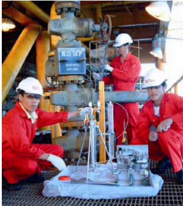
Fig. 1. Inyección de radiotrazadores en una plataforma petrolífera en Viet Nam.
