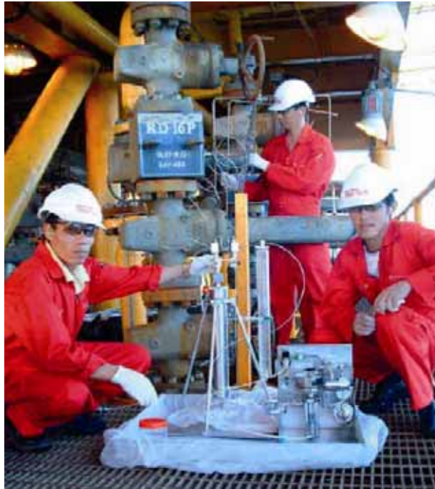
FIG. 1. Iniection de radiotraceurs sur une plate-forme de forage au Vietnam.
