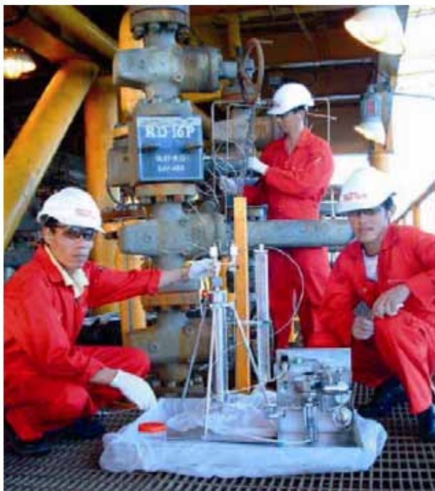
图 1. 在越南的一个近海油田钻井平台上进行放射性示踪剂注入。
