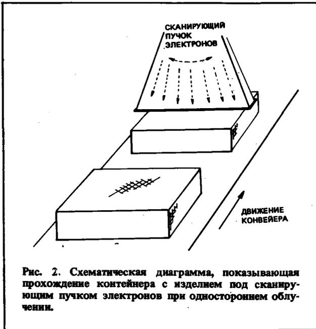
Рис. 2. Схематическая диаграмма, показывающая прохождение контейнера с изделием под сканирующим пучком электронов при одностороннем облучении.
