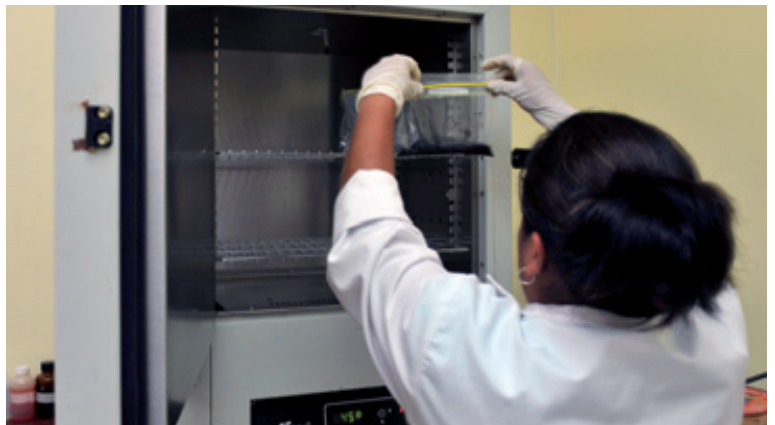
13 D'autres membres de l'équipe étiquettent ensuite les échantillons et les marquent selon la couleur, la texture, l'odeur, etc. Les échantillons sont ensuite séchés à température contrôlée dans un four avant d'être expédiés aux laboratoires participants qui les analyseront.
