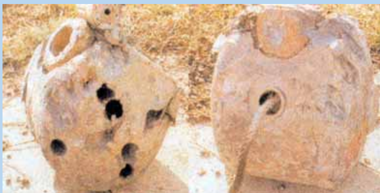
Cabezales de teleterapia dañados (OIEA).
