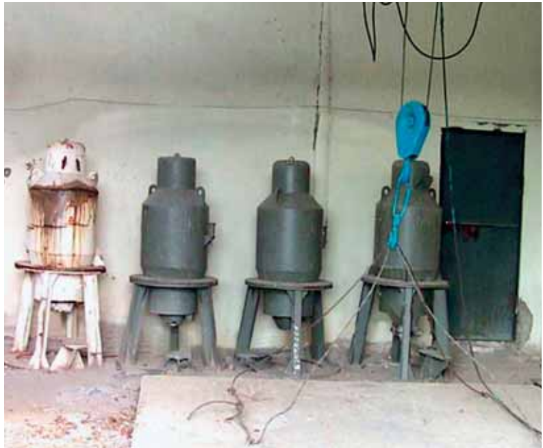
Fuentes utilizadas en los irradiadores de cesio móviles en la antigua Unión Soviética con 130 TBq (~3500 curios) de cesio 137. (Unión Soviética)/OIEA
