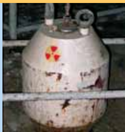
Контейнер для перевозки закрытых радиоактивных источников в плохом состоянии В. Фридрих (МАГАТЭ)
