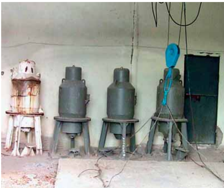
Источники, использовавшиеся в бывшем Советском Союзе в переносных облучателях на основе цезия с активностью 130 ТБк (~ 3500 Кюри) цезия-137. (Советский Союз)/МАГАТЭ
