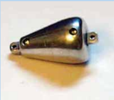
Source de radiographie industrielle. Ce type de source était utilisé aux États-Unis dans les années 1930 et 1940 pour inspecter les soudures et le coulage des métaux.
