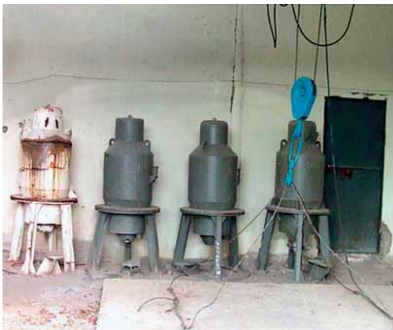
Sources utilisées dans des irradiateurs portatifs dans l'ex-Union soviétique contenant 130 TBq (environ 3500 curies) de césium 137. (Union soviétique)/AIEA
