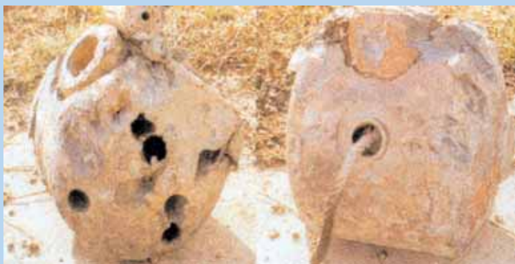
Photo de couverture : Têtes radiogènes endommagées (AIEA).
