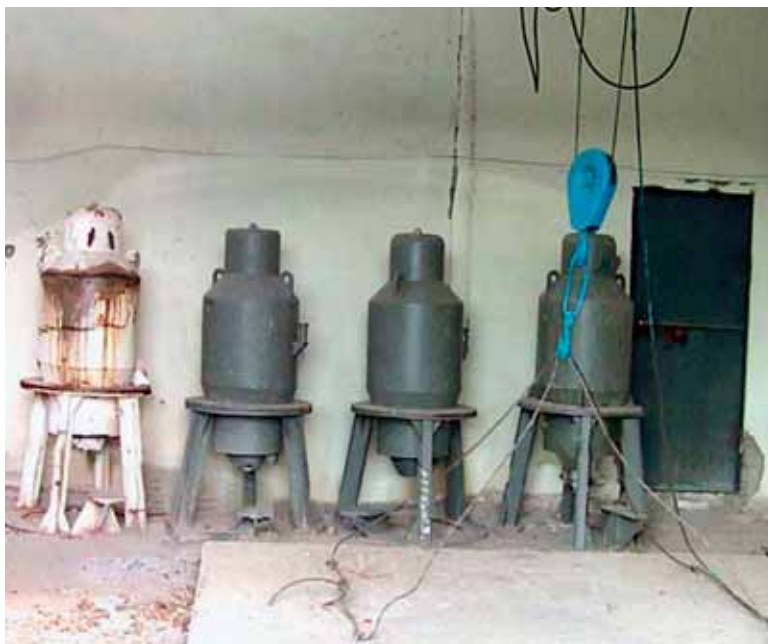
前苏联移动式铯辐照器中所用的源含有 130 太贝可（约 3500 居里）铯-137。（苏联）/原子能机构
