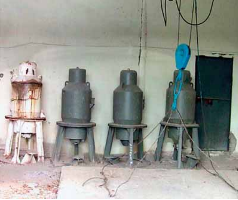
مصادر استخدمت في مُشعّات متنقلة قائمة على السيزيوم في الاتحاد السوفييتي سابقاً تحتوي على ١٣٠ تيرا بكريل (تقريباً ٣٥٠٠ كوري) من السيزيوم-١٣٧. (الاتحاد السوفييتي)/الوكالة
