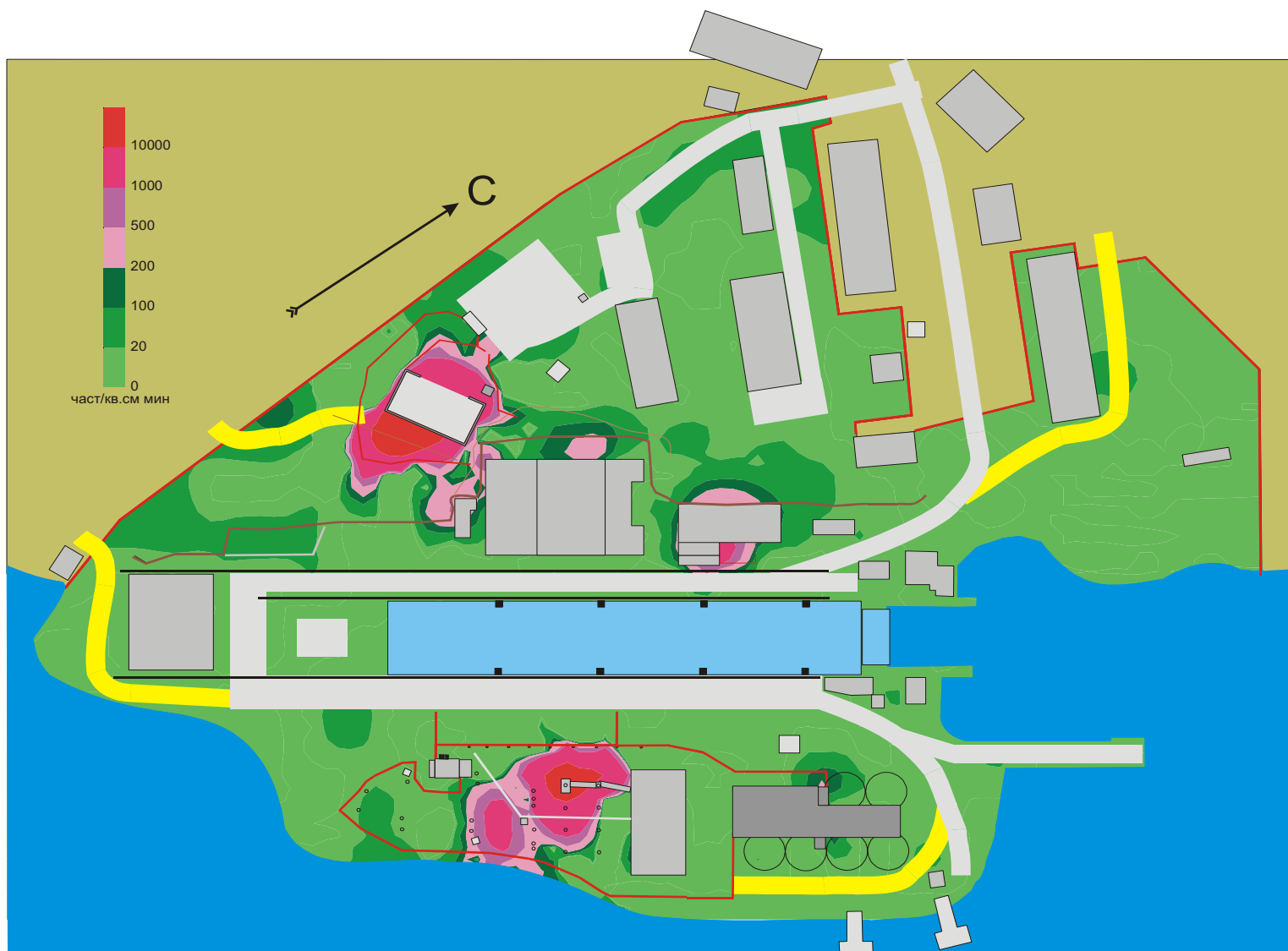
Рис. 4б. Плотность потока \beta излучения на территории ПВХ РАО и ОЯТ в п. Гремиха
