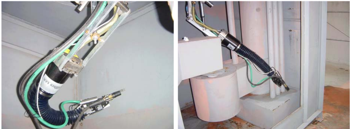
Рис. 1. Манипулятор для дезактивации горячей камеры на стенде
