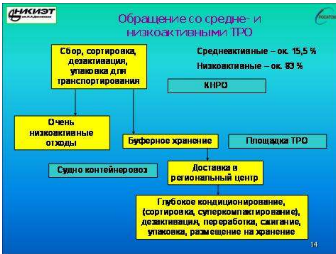
Рис. 8 Обращение со средне и низкоактивными твердыми отходами.
