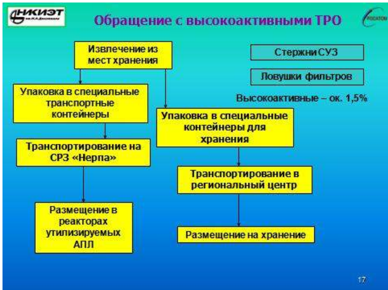
Рис. 11 Обращение высокоактивными твердыми радиоактивными отходами.
