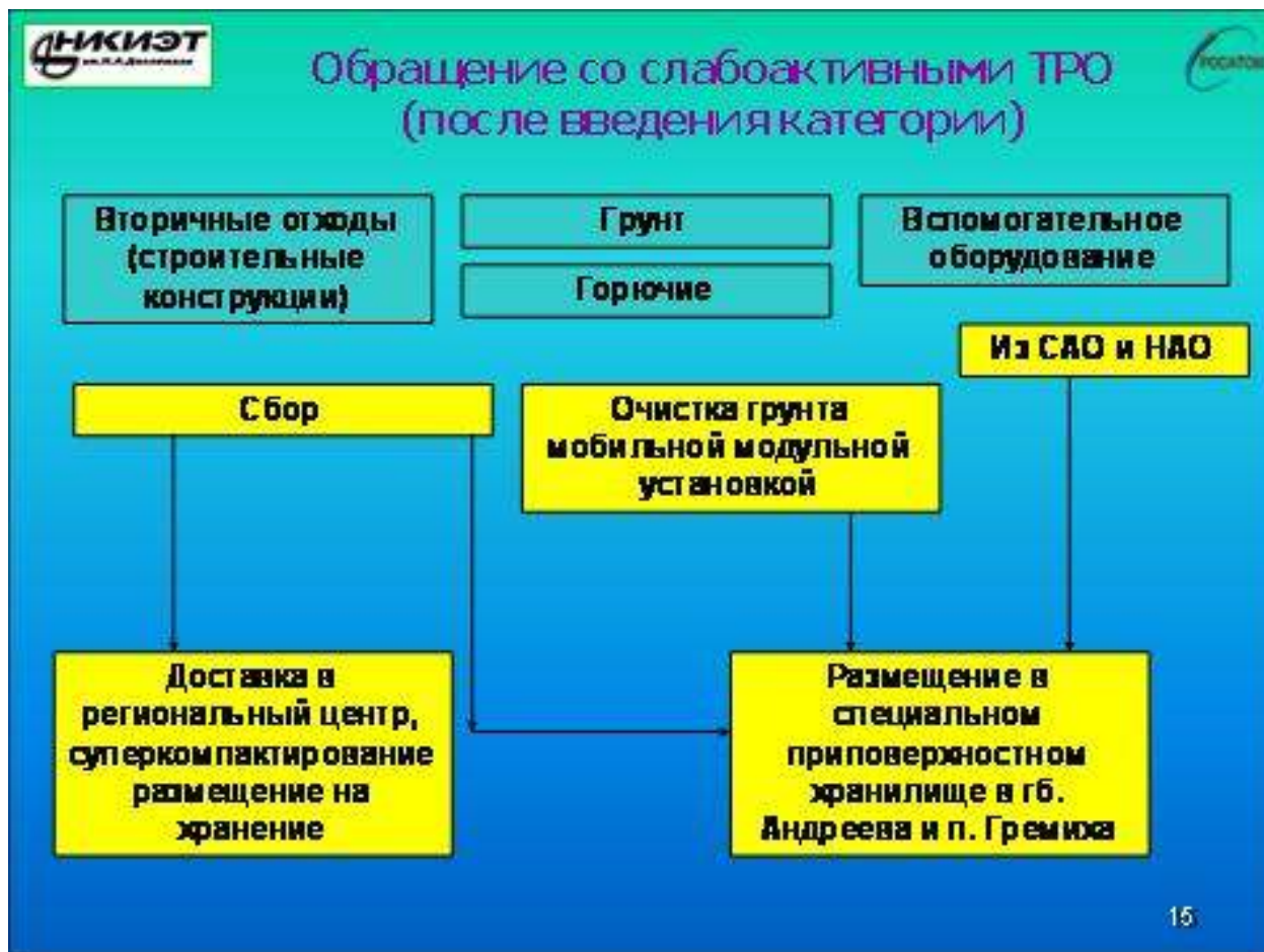
Рис. 9 Обращение очень низкоактивными твердыми отходами (после введения категории).
