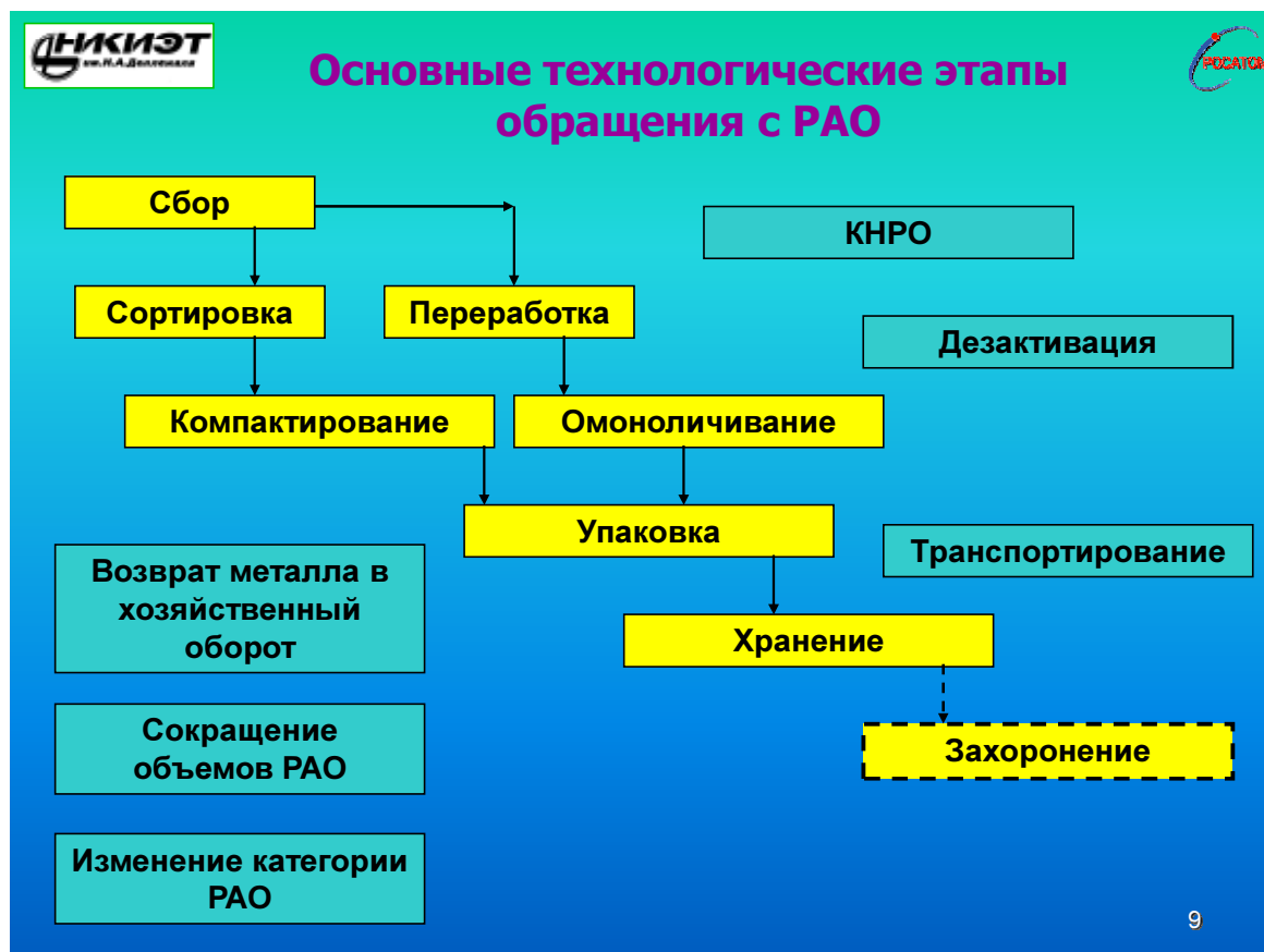
Рис. 6 Основные укрупненные технологические этапы обращения с РАО.
