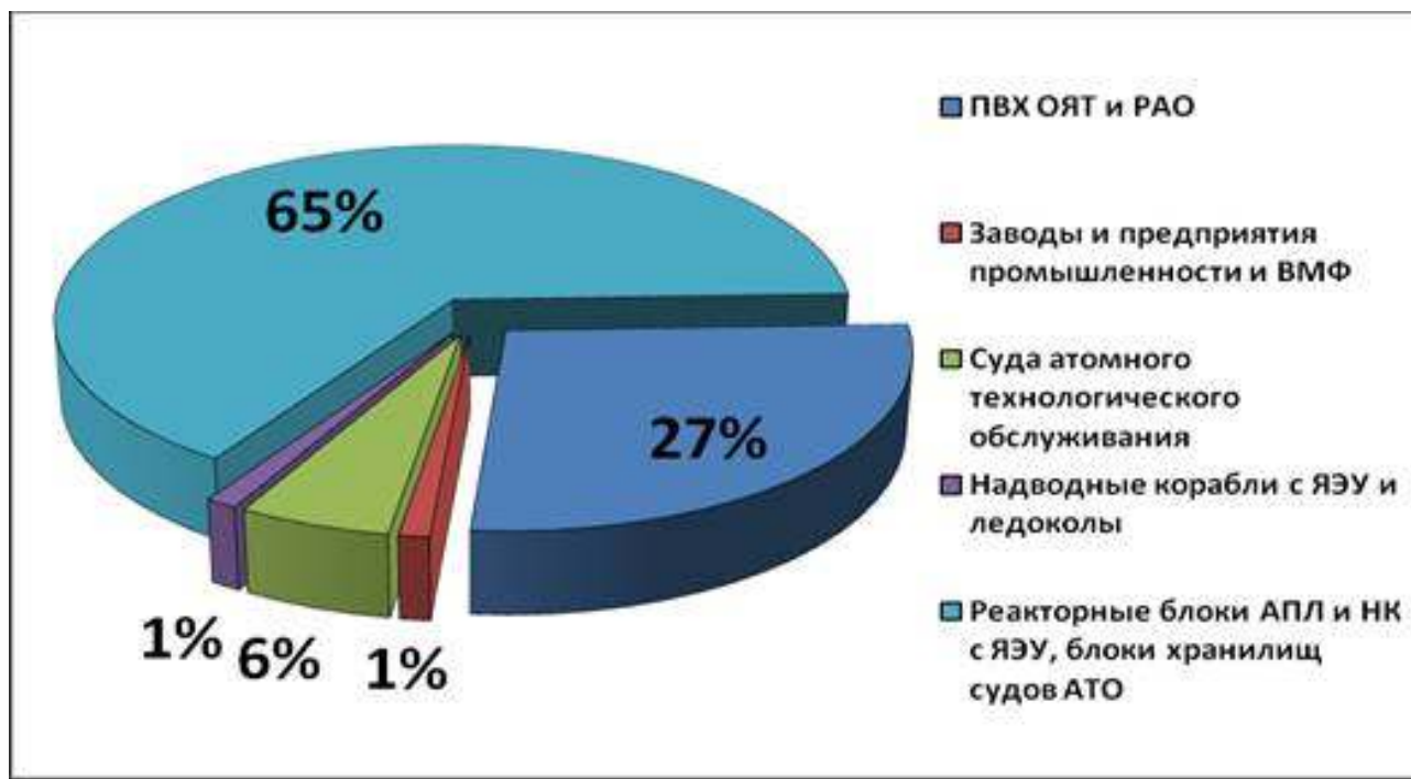
Рис. 3 Диаграмма соотношения планируемых к образованию радиоактивных отходов по источникам образования.
