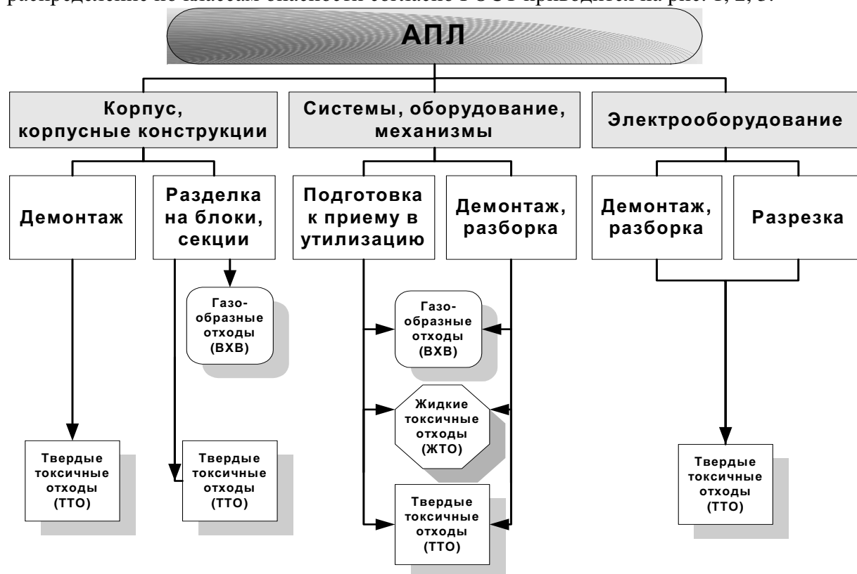
Рис. 1. Схема образования токсичных отходов при утилизации АПЛ
